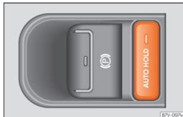
Fig. 245 Dettaglio della console centrale: tasto dell'Auto Hold.
