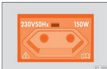
Fig. 198 Console centrale per i sedili posteriori: presa di corrente europea da 230 V.
