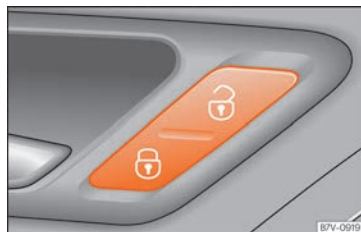
Fig. 132 Sulla porta del conducente: pulsante della chiusura centralizzata.
