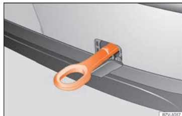
Fig. 75 Nel paraurti posteriore, sul lato destro: Occhiello di traino avvitato
