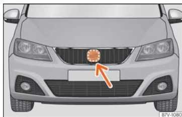
Fig. 263 Nella parte anteriore, dietro allo stemma SEAT: sensore radar.
