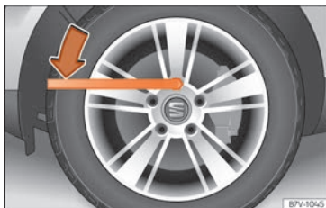
Fig. 69 Cambio di una ruota: allentare i bulloni della ruota.
