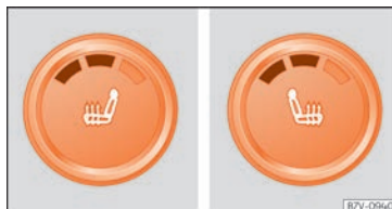
Fig. 158 Dettaglio della console centrale: comandi per il riscaldamento dei sedili anteriori, con il secondo livello di temperatura regolato.
