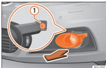
Fig. 111 Nella parte destra del paraurti anteriore: rimozione dei fari.
