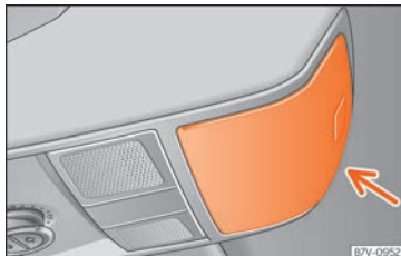
Fig. 179 Nella console del tetto: vano portaocchiali.
