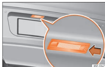
Fig. 117 Nel paraurti posteriore: illuminazione della targa.
