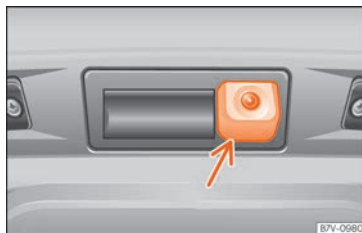
Fig. 253 Nel portellone posteriore: posizione della telecamera dell'assistente alla retromarcia.
