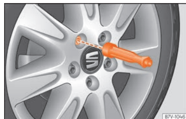
Fig. 73 Cambio di una ruota: allentare i bulloni della ruota con l'impugnatura del cacciavite.
