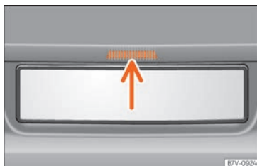
Fig. 9 Apertura del portellone posteriore dall'esterno.
