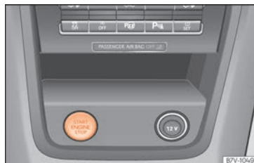
Fig. 237 Sulla console centrale: pulsante di avviamento del sistema di chiusura e avviamento senza chiave Keyless Access. Nei veicoli con volante a destra, la disposizione è simmetrica.
