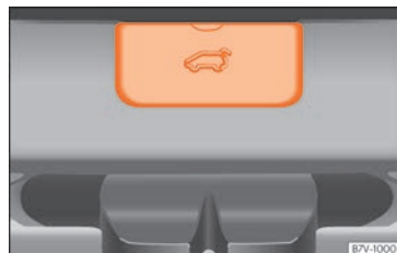
Fig. 10 Dal bagagliaio: smontaggio della copertura del portellone posteriore.
