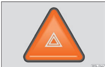
Fig. 144 Al centro del cruscotto: pulsante del lampeggio d'emergenza.
