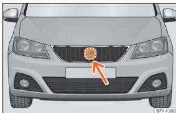
Fig. 259 Nella parte anteriore, dietro allo stemma SEAT: sensore radar.
