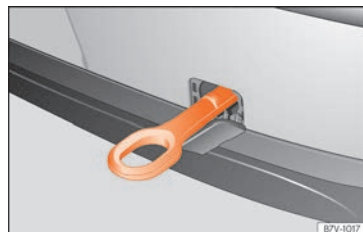
Fig. 106 Nel paraurti posteriore, sul lato destro: Occhiello di traino avvitato
