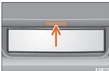
Fig. 141 Apertura del portellone posteriore dall'esterno.
