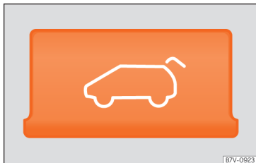
Fig. 8 Dettaglio della console centrale: tasto di sbloccaggio per il portellone posteriore.
