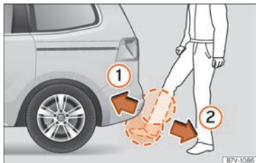
Fig. 142 Portellone del bagagliaio con apertura controllata da sensore (Easy Open).
