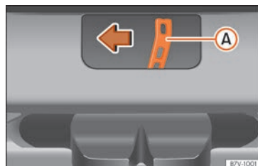
Fig. 11 Dal bagagliaio: sbloccaggio di emergenza del portellone posteriore.
