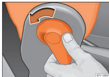
Fig. 164 Sbloccare lo schienale ribaltabile del sedile del passeggero.
