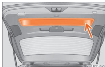
Fig. 139 Portellone posteriore aperto: maniglia di presa ad incavo.
