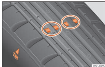
Fig. 302 Spessore del battistrada dello pneumatico: indicatori di usura.
