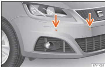
Fig. 247 Sensori di controllo del parcheggio nel paraurti anteriore.
