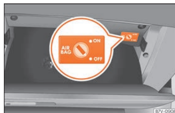
Fig. 94 Nel cassetto portaoggetti, lato passeggero: interruttore a chiave per attivare e disattivare l'airbag frontale del passeggero.
