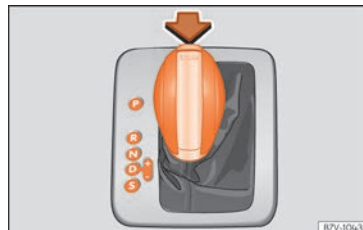
Fig. 51 Cambio automatico: posizioni della leva selettoria.
