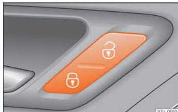
Fig. 4 Sulla porta del conducente: pulsante della chiusura centralizzata.
