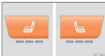
Fig. 159 Dettaglio della console centrale: telecomandi per il riscaldamento dei sedili anteriori nei veicoli dotati di Climatronic.
