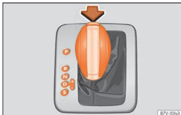
Fig. 241 leva selettoria del cambio automatico con tasto di blocco (freccia).
