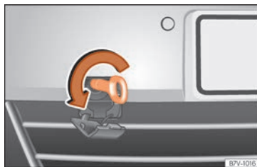
Fig. 74 Nella parte destra del paraurti anteriore: avvitare l'occhiello di traino.
