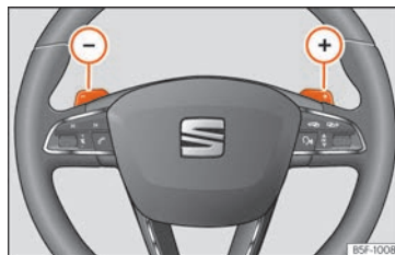
Fig.243 Volante con due leve per Tiptronic.
