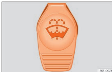
Fig. 60 Nel vano motore: tappo del serbatoio del tergilavafari.
