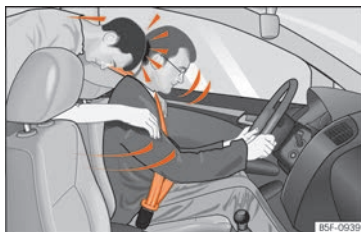
Fig. 88 Non indossando la cintura di sicurezza, il passeggero seduto sul sedile posteriore viene scagliato in avanti, colpendo il conducente (che invece indossa la cintura)
