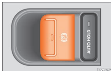
Fig. 239 Dettaglio della console centrale: interruttore del freno di stazionamento elettronico.
