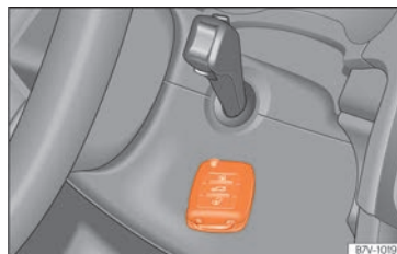
Fig. 238 Avviamento di emergenza su veicoli con Keyless Access.
