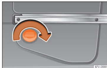
Fig. 288 Nella parte posteriore sinistra del bagagliaio: serbatoio di AdBlue, protetto da un coperchio.
