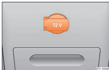
Fig. 197 Parte posteriore della console centrale: presa elettrica da 12 Volt.
