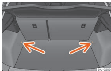
Abb. 165 Anordnung der Verzurrösen im Gepäckraum.
