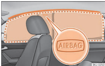
Abb. 29 Einbauort und Entfaltungsbereich des Kopfairbags.
