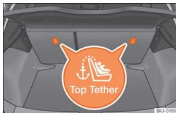
Abb. 35 Lage der Top Tether-Ösen im hinteren Teil des Rücksitzes
