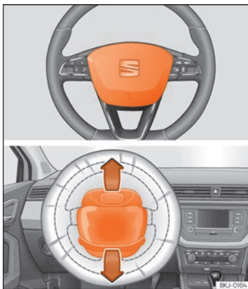
Abb. 23 Einbauort Fahrerairbag: im Lenkrad.
