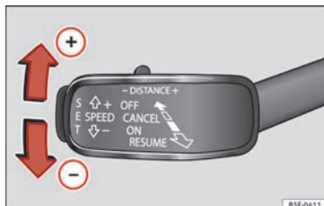
Fig. 205 A sinistra del piantone dello sterzo: terza leva per utilizzare il sistema di regolazione automatica della velocità.
