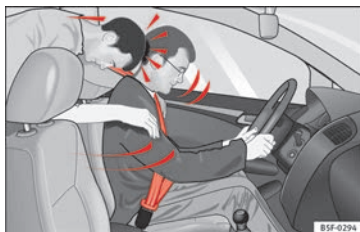
Fig. 90 Se non indossa la cintura, il passeggero seduto sul sedile posteriore viene scagliato in avanti, colpendo il conducente (che invece indossa la cintura)
