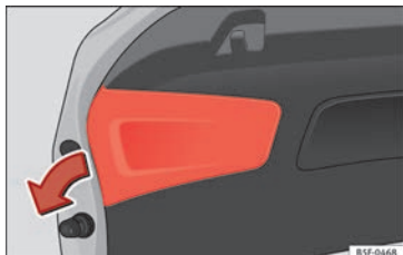
Fig. 115 Come rimuovere la copertura nel portellone
