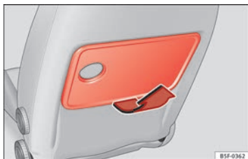
Fig. 155 Sedile anteriore sinistro: tavolinetto ripiegabile.
