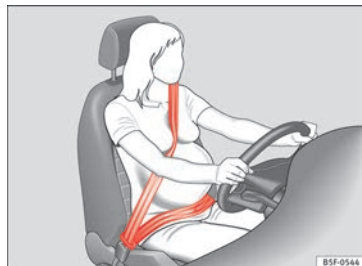
Fig. 92 Posizione del nastro della cintura di sicurezza per donne in stato di gravidanza.
