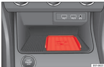
Fig. 128 Console centrale: Connectivity Box
