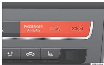
Fig. 93 Spia di controllo sul cruscotto per la disattivazione dell'airbag frontale del passeggero.
