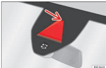
Fig. 218 Nel parabrezza: area del campo visivo della telecamera del dispositivo di assistenza per il mantenimento della corsia.
