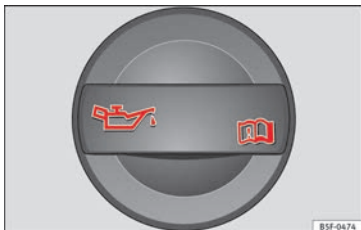
Fig. 249 Vano motore: tappo del bocchettone di rifornimento dell'olio motore.
