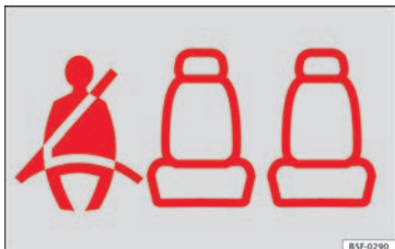
Fig. 87 Quadro strumenti: indicazione di sedile posteriore destro occupato e di corrispondente cintura di sicurezza allacciata.
