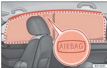
Fig. 27 Posizione degli airbag per la testa.
