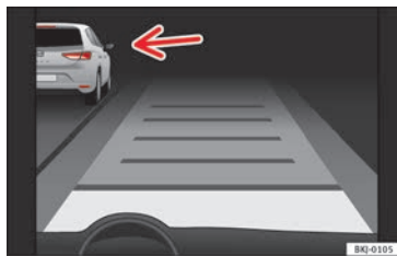
Fig. 208 Sul display del quadro strumenti: ACC attivo, veicolo rilevato sulla sinistra
