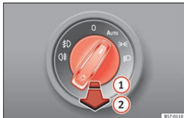
Fig. 139 Plancia portastrumenti: interruttore delle luci.
