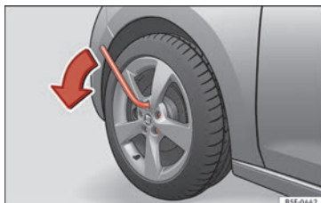
Fig. 72 Ruota: allentare le viti della ruota.
