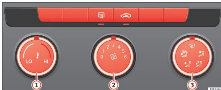
Fig. 57 Sulla console centrale: comandi dell'impianto di riscaldamento e di ventilazione.
