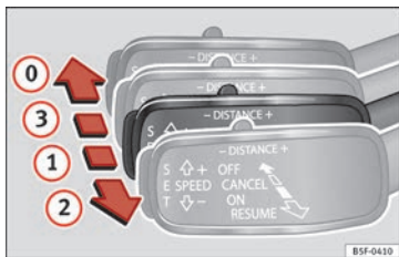
Fig. 204 A sinistra del piantone dello sterzo: terza leva per utilizzare il sistema di regolazione automatica della velocità.
