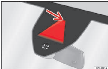
Fig. 216 Nel parabrezza: area del campo visivo della telecamera del dispositivo di assistenza per il mantenimento della corsia.
