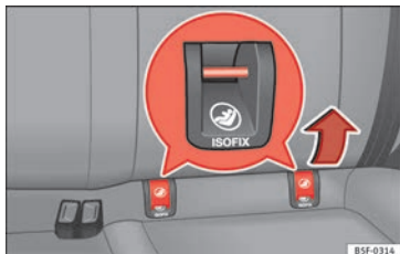
Fig. 32 Occhielli di fissaggio del sistema ISOFIX.
