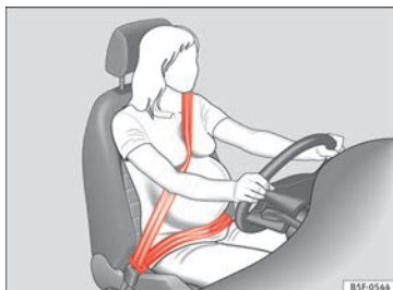
Fig. 94 Posizione del nastro della cintura di sicurezza per donne in stato di gravidanza.
