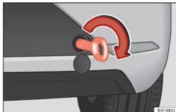
Fig. 100 Paraurti posteriore destro: occhiello di traino avvitato.
