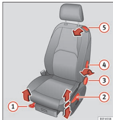
Fig. 13 Sedili anteriori: regolazione manuale del sedile.
