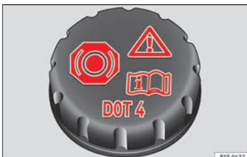
Fig. 64 Vano motore: tappo del serbatoio del liquido dei freni.
