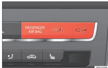
Fig. 23 Plancia portastrumenti: spia della disattivazione degli airbag del passeggero anteriore.
