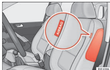
Fig. 26 Airbag laterale all'interno del sedile del conducente.
