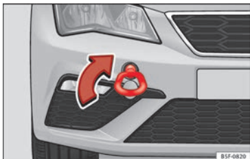
Fig. 98 Paraurti anteriore destro: occhiello di traino avvitato.
