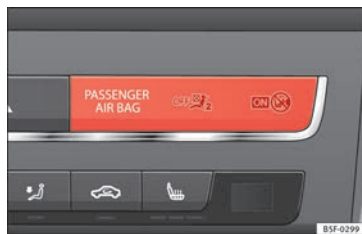
Fig. 96 Plancia portastrumenti: spia della disattivazione degli airbag del passeggero anteriore.
