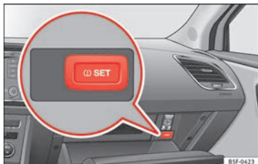
Fig. 254 Cassetto portaoggetti: interruttore per il controllo degli pneumatici.
