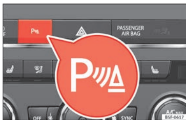
Fig. 226 Consolle centrale: tasto dell'assistenza per il parcheggio.
