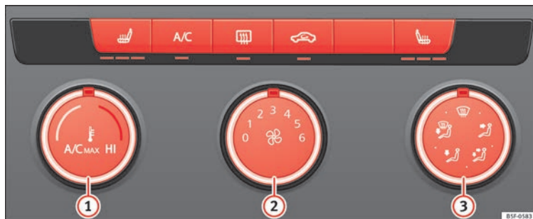
Fig. 58 Sulla console centrale: comandi manuali del climatizzatore.
