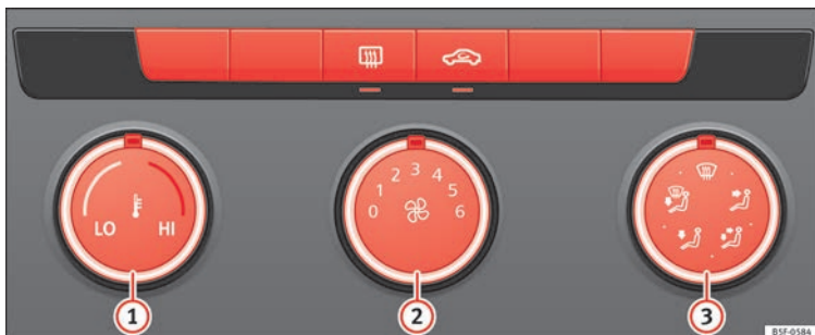
Fig. 59 Sulla console centrale: comandi dell'impianto di riscaldamento e di ventilazione.
