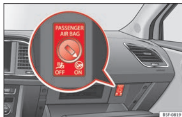
Fig. 95 Interruttore a chiave per l'attivazione e la disattivazione dell'airbag del passeggero.
