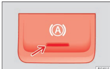
Fig. 202 Nella parte inferiore della console centrale: tasto della funzione Auto Hold.
