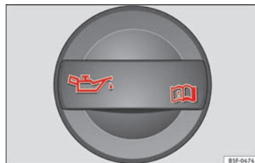
Fig. 62 Vano motore: tappo del bocchettone di rifornimento dell'olio motore.
