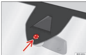
Fig. 148 Superficie sensibile del sensore pioggia
