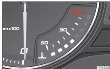
Fig. 124 Quadro strumenti: indicatore della temperatura del liquido di raffreddamento
