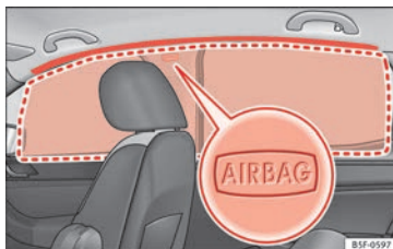
Fig. 28 Posizione degli airbag per la testa.
