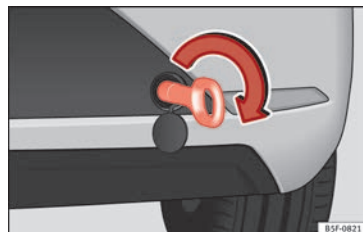
Fig. 78 Paraurti posteriore destro: occhio di traino avvitato.
