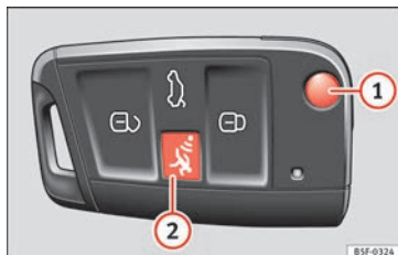
Fig. 133 Chiave del veicolo con pulsante di allarme.
