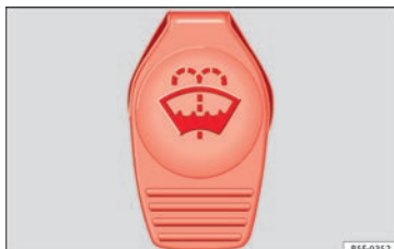
Fig. 65 Nel vano motore: tappo del serbatoio del tergicristalli.
