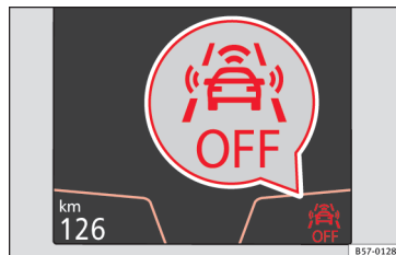
Fig. 206 Sul display del quadro strumenti: indicazione di Front Assist disattivato.
