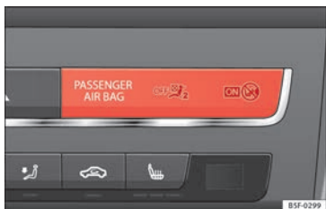
Fig. 53 Spia per la disattivazione dell'airbag del passeggero.
