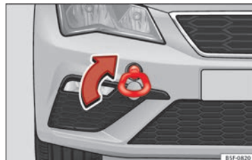
Fig. 77 Paraurti anteriore destro: occhio di traino avvitato.
