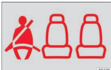
Fig. 89 Quadro strumenti: indicazione di sedile posteriore destro occupato e di corrispondente cintura di sicurezza allacciata.
