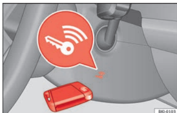
Fig. 193 A destra del piantone dello sterzo: avviamento di emergenza.
