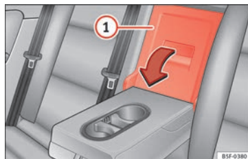
Fig. 175 Sullo schienale del sedile posteriore: apertura della sponda.
