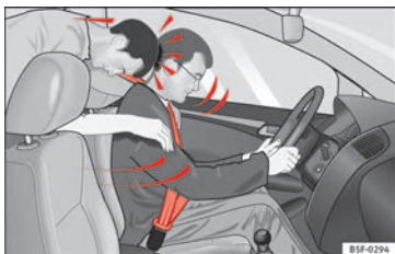
Fig. 92 Se non indossa la cintura, il passeggero seduto sul sedile posteriore viene scagliato in avanti, colpendo il conducente (che invece indossa la cintura)
