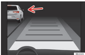
Fig. 213 Sul display del quadro strumenti: ACC attivo, veicolo rilevato sulla sinistra
