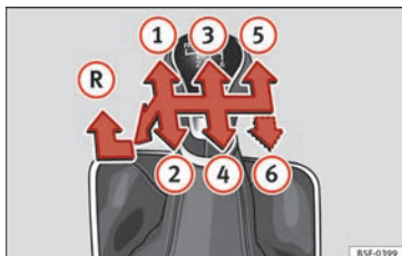
Fig. 54 Schema di un cambio manuale a 5 marce o a 6 marce.
