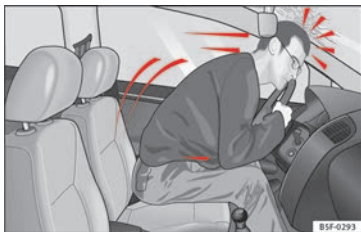
Fig. 91 Il conducente che non indossa la cintura di sicurezza viene scaraventato in avanti
