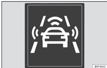
Fig. 204 Sul display del quadro strumenti: indicazioni di preavvertimento.
