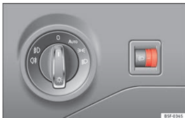
Fig. 144 Accanto al volante: regolatore della profondità dei fari.
