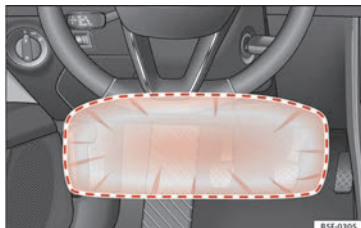
Fig. 25 Sul lato del conducente: raggio d'azione dell'airbag per le ginocchia.
