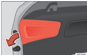
Fig. 116 Rimuovere la copertura del portellone posteriore.
