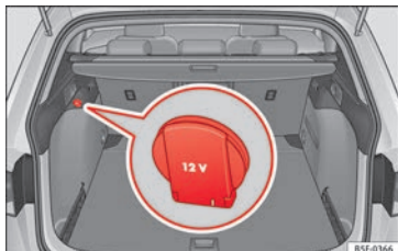
Fig. 162 Particolare del rivestimento laterale del bagagliaio: presa di corrente a 12 V (valido solo per il modello LEON ST).
