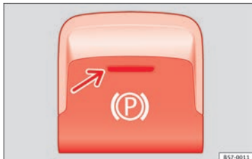
Fig. 195 Nella parte inferiore della console centrale: tasto del freno di stazionamento elettronico.
