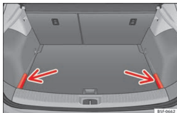
Fig. 167 Nel bagagliaio: coperchi per la riposizione del pianale portaoggetti
