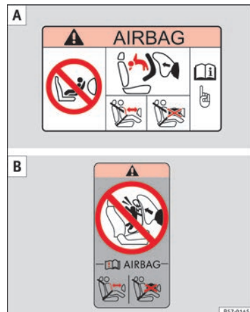
Fig. 29 Adesivi dell'airbag - versione 1: sull'altoparlante lato passeggero A e nel telaio posteriore della porta del passeggero B .
