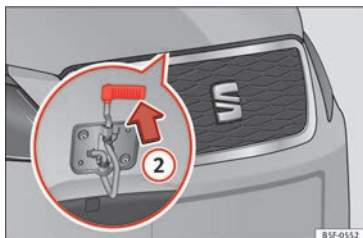
Fig. 9 Leva sotto il cofano del vano motore.
