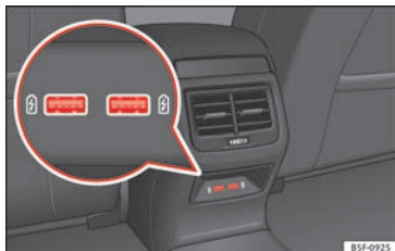
Fig. 129 Parte posteriore della consolle centrale: connettori USB.
