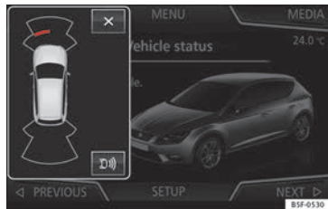
Fig. 227 Indicazione in miniatura dell'attivazione automatica
