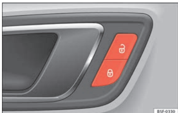
Fig. 2 Porta del conducente: interruttore della chiusura centralizzata.
