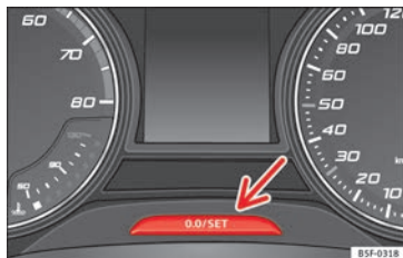
Fig. 123 Quadro strumenti: contachilometri e tasto di azzeramento.
