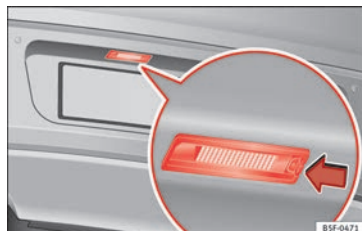
Fig. 118 Nel paraurti posteriore: luce della targa.
