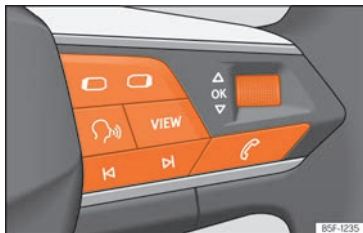
Fig. 59 Partie droite du volant multifonction : touches permettant d'utiliser les menus et les messages d'information du combiné d'instruments.
