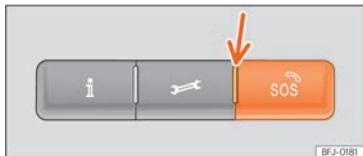
Fig. 30 Sur la console de pavillon : commande pour les services vocaux
