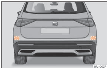
Fig. 170 Vue arrière du véhicule : zones des capteurs radars.
