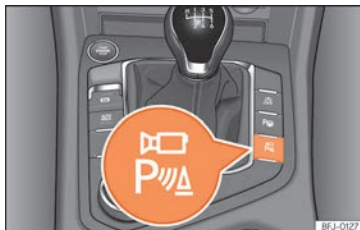
Fig. 210 Console centrale : touche permettant d'activer ou de désactiver manuellement le système de vision périphérique lorsqu'il est associé au système d'aide au stationnement.
