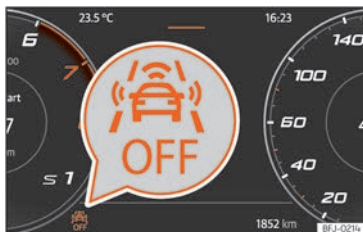
Fig. 178 Sur l'écran du combiné d'instruments : indication de Front Assist désactivé.
