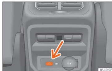
Fig. 157 Partie arrière de la console centrale : connecteurs USB avec fonction de prise de courant.
