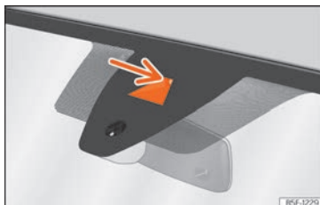
Fig. 169 Sur le pare-brise : fenêtre de l'assistant de maintien de voie.
