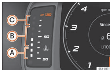
Fig. 58 Combiné d'instruments numérique : indicateur de température du liquide de refroidissement du moteur.
