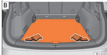
Fig. 121 Dans le coffre à bagages : régler le plancher modulaire du coffre en hauteur.
