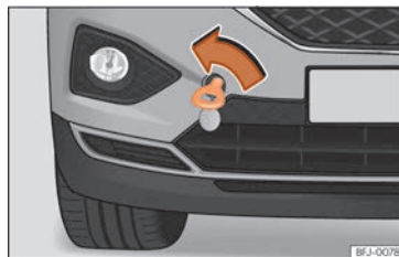
Fig. 46 Du côté droit du pare-chocs avant : œillet de remorquage vissé
