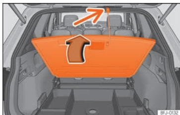
Fig. 120 Dans le coffre à bagages : soulever le plancher du coffre.
