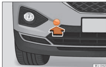
Fig. 45 Du côté droit du pare-chocs avant : retirer le cache.
