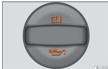
Fig. 224 Dans le compartiment-moteur : bouchon de l'orifice de remplissage d'huile moteur.
