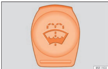
Fig. 228 Dans le compartiment-moteur : bouchon du réservoir de liquide lave-glace.
