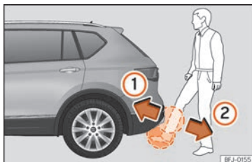
Fig. 83 Hayon du coffre à bagages à ouverture contrôlée par capteur (Easy Open).
