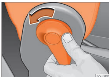
Fig. 110 Débloquent le dossier rabattable du siège du passager.
