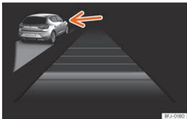
Fig. 182 Sur l'écran du combiné d'instruments : ACC activé, véhicule circulant à gauche détecté
