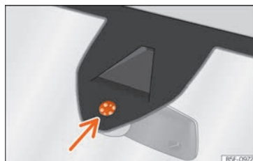
Fig. 96 Surface sensible du détecteur de pluie.
