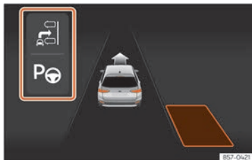
Fig. 197 Sur l'écran du combiné d'instruments : affichage du système de stationnement assisté avec affichage réduit.
