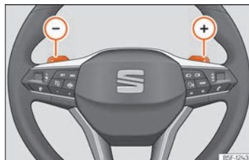
Fig.164 Volant : palettes pour boîte automatique.
