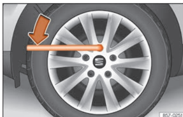
Fig. 35 Changement de roue : desserrer les vis de roue.
