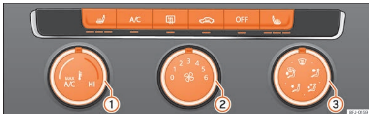
Fig.144 Sur la console centrale : commandes du climatiseur manuel.
