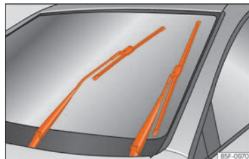
Fig. 40 Essuie-glace en position d'entretien.
